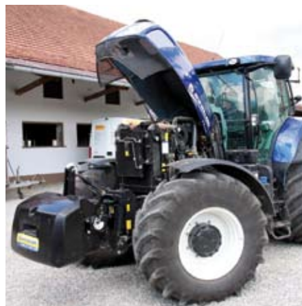
Der Motor hat einen Hubraum von 6,75 l. Die Maximalleistung beträgt 249 PS/183 kW, mit Boost 269 PS/198 kW.
