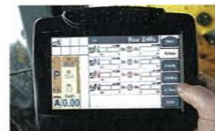
Die Durchflussmengen- und Zeiteinstellung der bis zu acht elektronischen Zusatzsteuergeräte lässt sich einfach und genau über den Touchscreen-Monitor erledigen.
