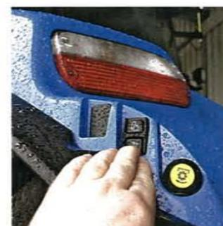
Am Kotflügel kann auch ein Zusatzsteuergerät bedient werden.
