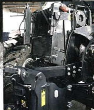
Die Kühler sind groß dimensioniert und lassen sich nach dem Aufschwenken passabel reinigen. Lieferbar ist auch ein Umkehrlüfter.
